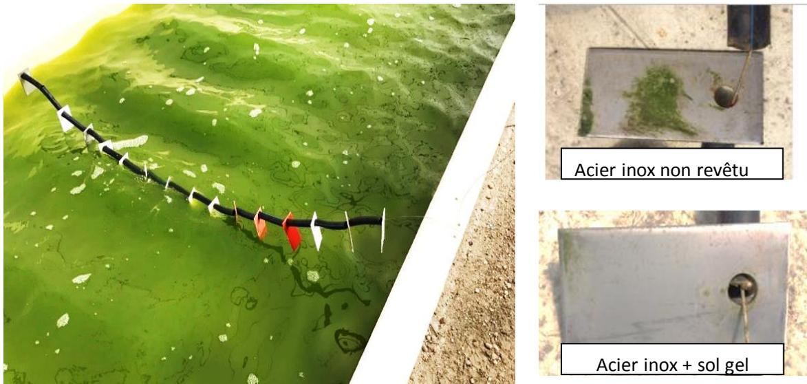
Figure 6. Installation d'échantillons dans la centrale électrique ENDESA
