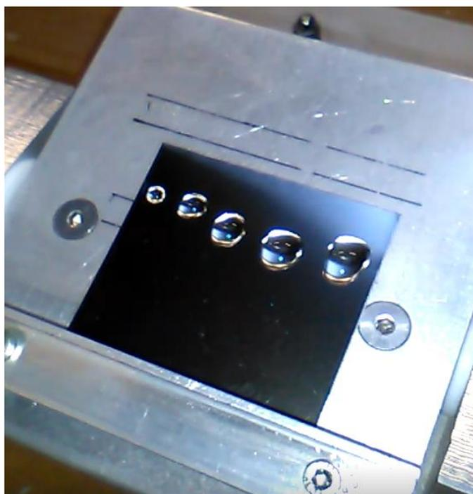
Figure 7 – Mesure Sliding angle (différentes tailles de goutte)
