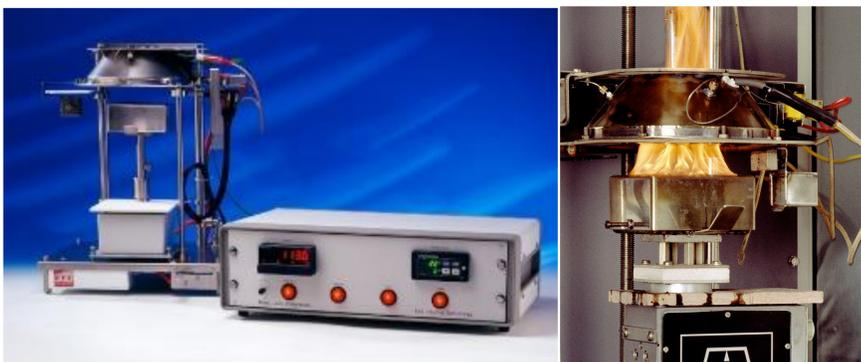
Mesure du débit calorifique et de la perte de masse au cours de l'essai
