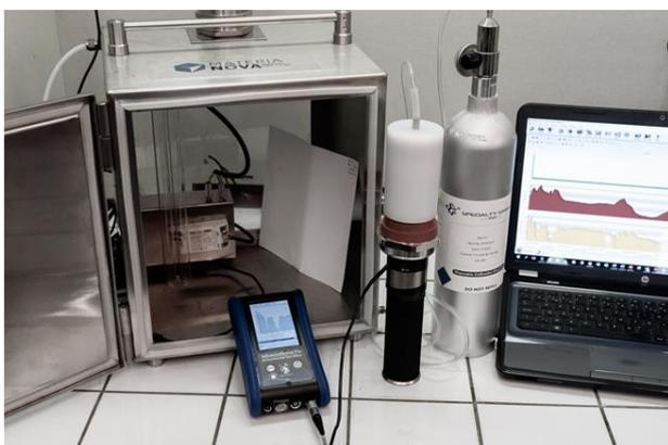
Figure 7 : Dispositif de mesure des COVs (Materia Nova)
